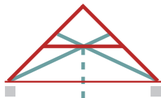
4a Kehlbalkendach mit Kreuzstreben und Hängestütze
