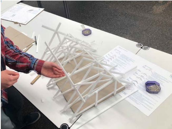
Ein Sparrendach aus Styrene-Streifen
